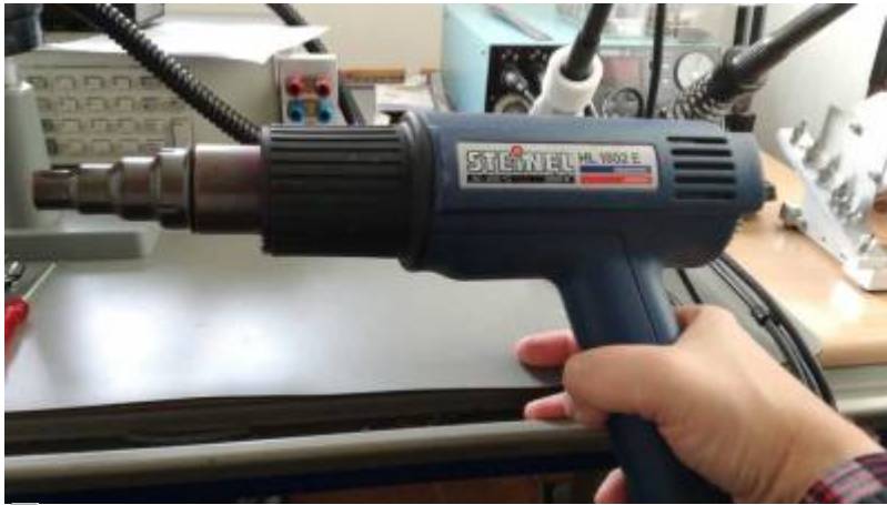
Heißluft-Pistole zum Auslöten, siehe Text
