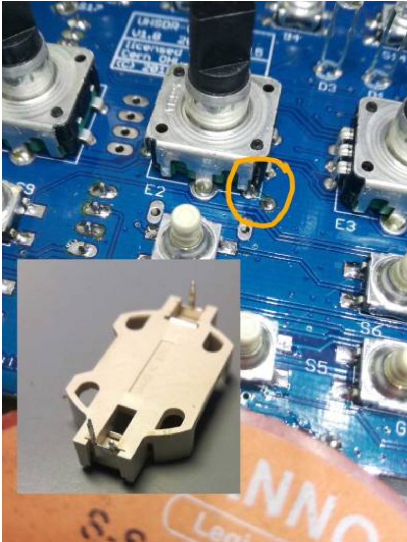
Möglicher Kurzschluß (photo DF9EH)
