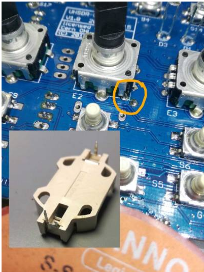
Court-circuit possible, à éviter (photo DF9EH)
