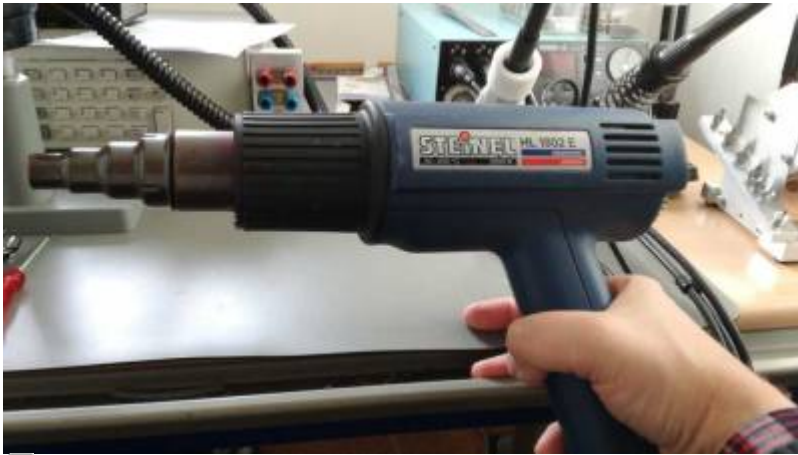
Pistolet à air chaud utilisé pour la désoudage - voir texte
