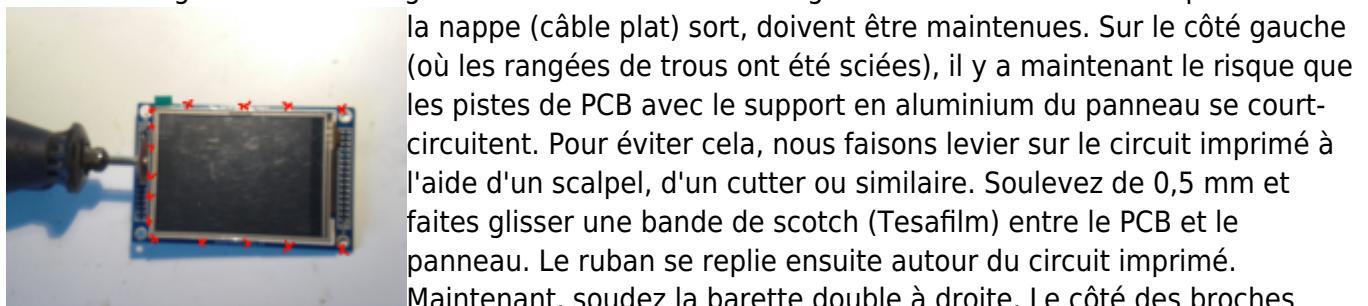
Maintenant, soudez la barette double à droite. Le côté des broches longues est insérée par le dessus (!!!) au travers des trous, puis la barette est soudée par le dessous. Cela évite le besoin d'enlever le plastique de la barette et la longueur des broches est juste assez longue pour assurer un contact. La plaque de support de l'écran LCD s'adapte maintenant bien au
