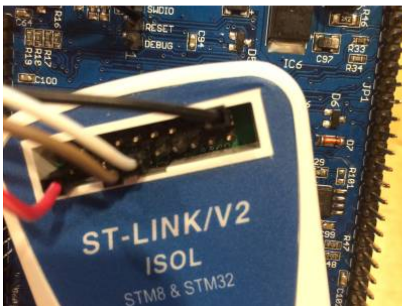
Connexion ST-Lien vers la carte d'interface utilisateur (photo F4HTX)
