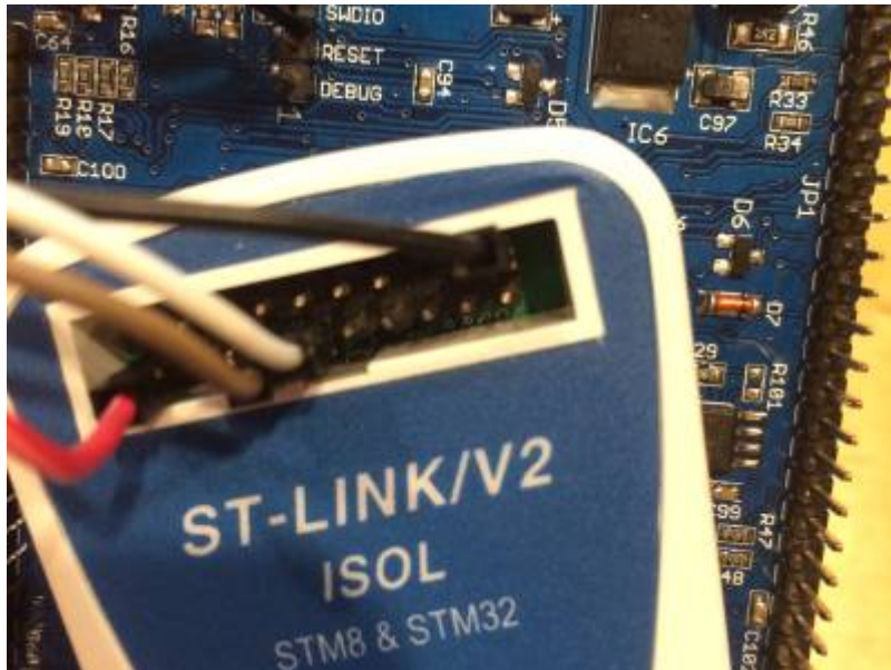
Connexion ST-Link vers la carte OVI40 UI (photo F4HTX)
