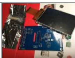
Displayboard, hier Ausführung zum Selberlöten (Foto: DL8EBD)
