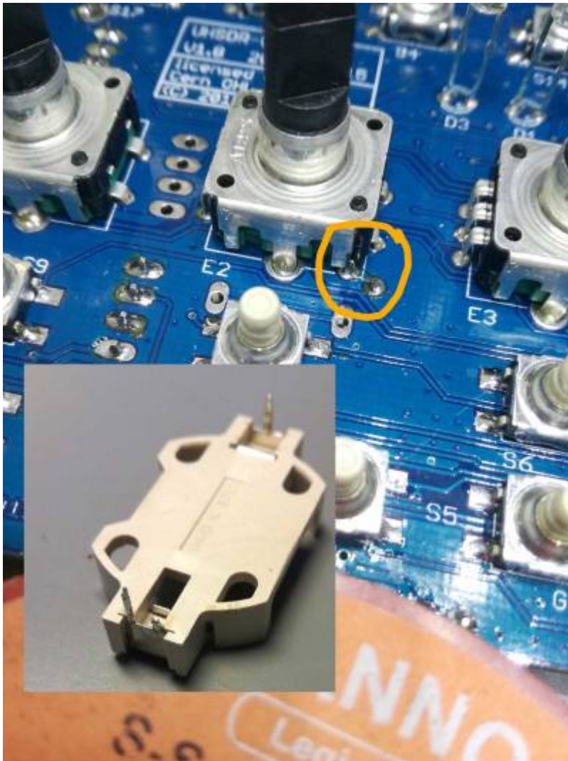
Möglicher Kurzschluß (photo DF9EH)
