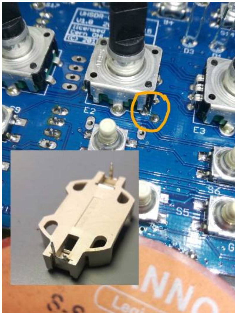
Möglicher Kurzschluß (photo DF9EH)
